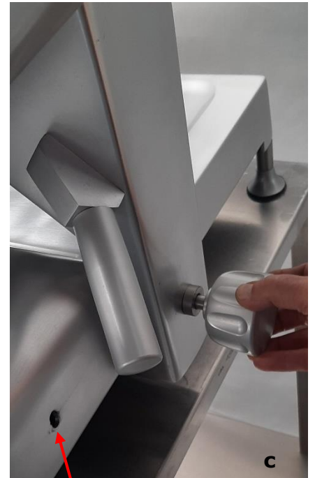
Trou d'indexage Desserrer le bouton de serrage du chariot
